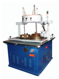
平面研磨设备工作原理:在平面磨床上,采用电磁吸盘工作台吸住工件,当线圈中通过直流电时,芯体被磁化,磁力线经过盖板-工件-盖板-吸盘体而闭合,工件被吸住。电磁吸盘工作台的绝磁层有铅、铜或巴合金等非磁性材料制成、它的作用是使绝大部分磁力线都通过工件磨削零件。磨床能加工硬度较高的材料,如淬硬钢、硬质合金等;也能加工脆性材料,如玻璃、花岗石。磨床能作高精度和表面粗糙度很小的磨削,也能进行高效率的磨削,如强力磨削等。随着高精度、高硬度机械零件数量的增加,以及精密铸造和精密锻造工艺的发展,磨床的性能、品种和产量都在不断的提高和增长。平面研磨设备也开始多样化发展,分工更详细,单面研磨,双面研磨机等。根据不同的需求采用不同的研磨配件,从而达到生产工艺需求。天津盲孔底双面研磨机保养温州市百城研磨机械有限公司致力于提供
